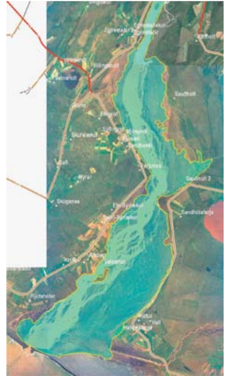
Á meðfylgjandi mynd má sjá hvernig rof á Heiðarlónsstíflu gæti litið út þegar mestra áhrifa gætir. Vatn umlykur bæinn Sauðholt II, en vatn næði ekki að öðrum núverandi mannvirkjum.
